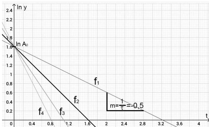
Man kann also im Diagramm die Steigung und den Achsenabschnitt ablesen und danach die Funktionsgleichung  $I(t)$  hinschreiben.
